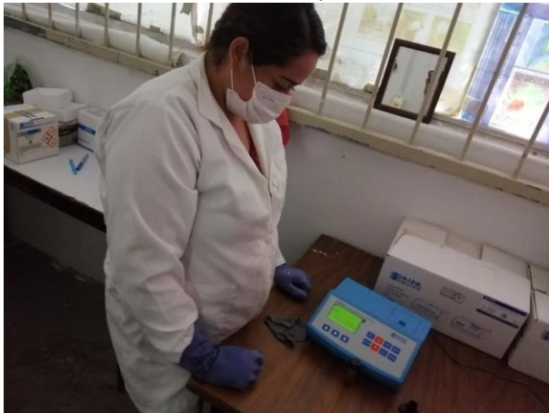
Determinación de la demanda química de oxígeno en las muestras de aguas residuales.
