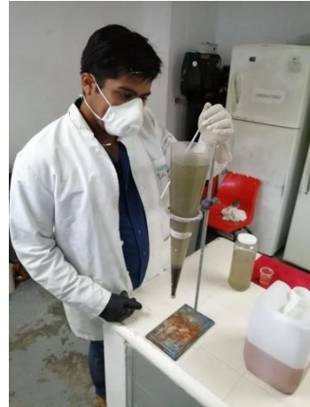
Determinación de sólidos sedimentables en las muestras de aguas residuales.
