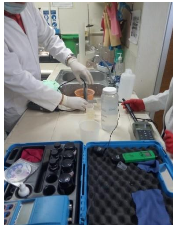
Determinación de turbiedad y oxígeno disuelto en las aguas residuales
