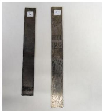
Seguidamente, todas las láminas fueron sonicadas en agua desionizada en un tiempo de 45 min utilizando el equipo sonicador BRANSON 2510, con el objetivo de eliminar los residuos (ver Figura 7).
