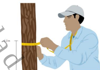
Figura 7. Medida a la altura de pecho. Forma correcta en la que se debe colocar la cinta diamétrica a 1.3 m de altura.
