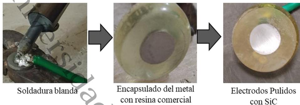
*Nota:* El secado del encapsulado se realizo a temperatura ambiente.
