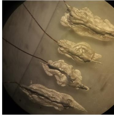
Figura 7.9: Acercamiento bajo microscopio de alambres de cobre pegados al sustrato mediante pintura de plata
