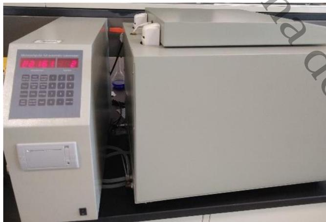
Figura 16 Equipo para medir calorimetría marca KL modelo LRY-900-1
