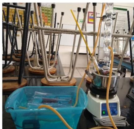
Figura 9 Equipo montado para la reacción de transesterificación
