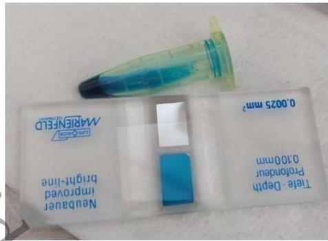
Figura 6. Cámara de Neubauer y Microtubo. Realización de viabilidad por el método de tinción.
