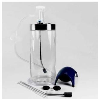
Figura 2. Fotobiorreactor, accesorios y bomba de aire. Fuente: UTEX (2024).
