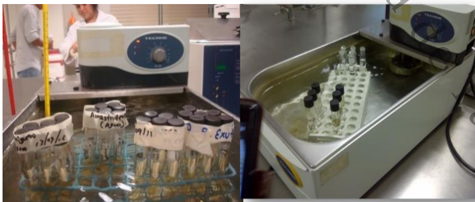
Figura 5 . Incubación a 44.5 °C en baño de agua con termo circulación, de tubos para la confirmación de CF
