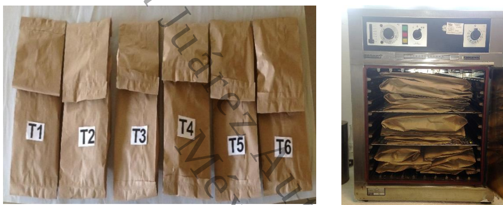
Figura 2.16. Procedimiento de secado de plántulas de eucalipto para la determinación de peso seco de biomasa aérea y radical.
