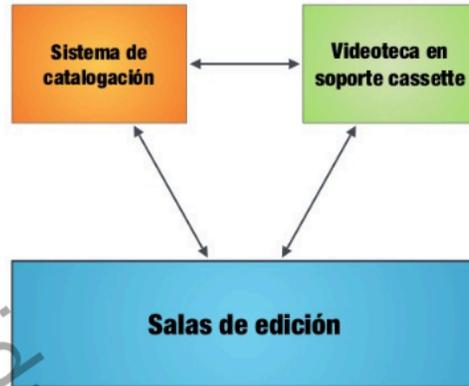
Ilustración 1 Tape-Based System (Sokusky & Wang, 2003).
