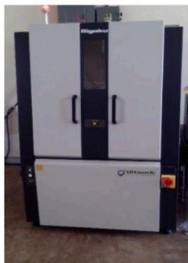
Fig. 2.3 Difractómetro de Rayos X Rigaku Ultima IV.
