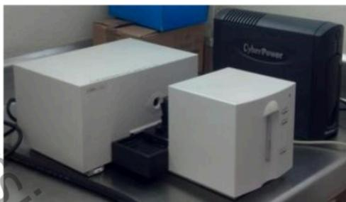
Fig.2.5 Espectrofotómetro Shimadzu UV-Vis.
