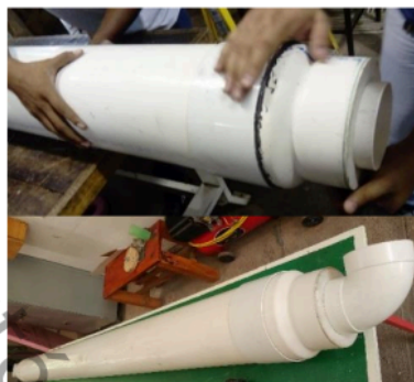
(d) Sellado de tubo aislado
