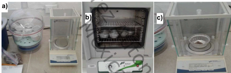
Figura 3.14 a) Selección y pesado de los granos; b) secado de la muestra y c) pesado de los granos secos. Fuente: propia.
