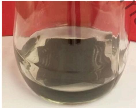
**Figura 3.11.** Limpieza de electrodo de tela de carbón 40% Pt, 0.3 mg/cm<sup>2</sup> para cámara anódica
