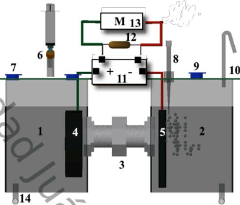
**Figura 3.9.** Esquema de la CCM de doble cámara. 1) Cámara anódica; 2) Cámara catódica; 3) MIP; 4) Ánodo; 5) Cátodo; 6) toma de muestra; 7) Entrada de fluido; 8) Entrada de aire; 9) Entrada de fluido; 10) Venteo atmosférico; 11) Tablero del circuito; 12) Resistencia externa; 13) Multímetro; 14) Salida de fluido.
