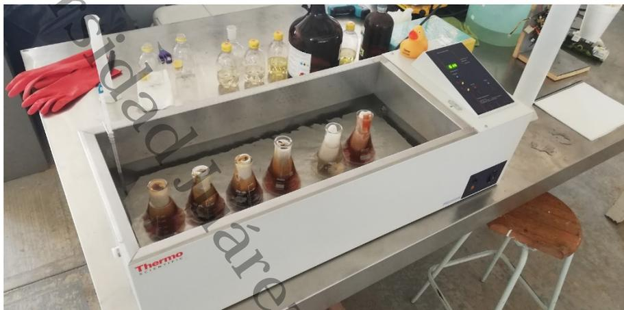
**Figura 14. Determinación de celulosa (Equipo de baño maría).**
