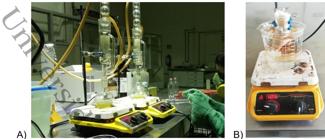
**Figura 13. Pruebas de extracción. A) Equipo de extracción Soxhlet; B) Extracción en agua caliente.**
