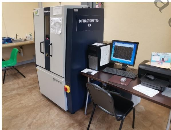
**Figura 17. Difractor de Rayos X (Instituto de Investigación e Innovación en Energías Renovables – UNICACH)**
