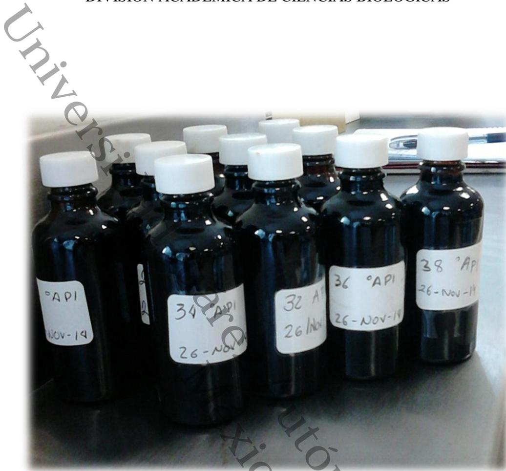
Ilustración 6. Anexo. Envasado de las mezclas de petróleo crudo con los diferentes grados API utilizados.
