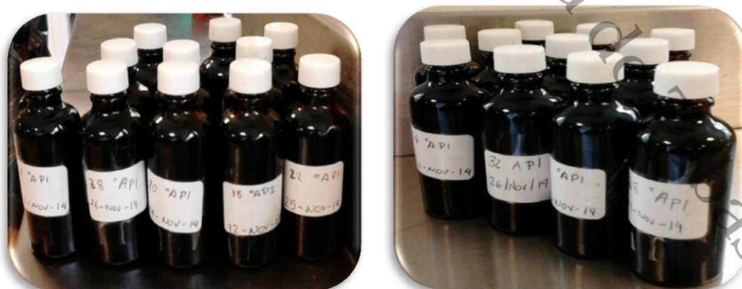
Figura 2. Mezclas de hidrocarburos de 14 a 38 grados API.
