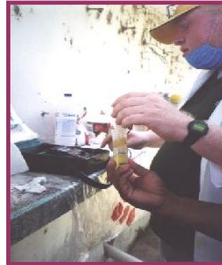
**Figura 13.-** Toma de muestra para coliformes totales y fecales.
