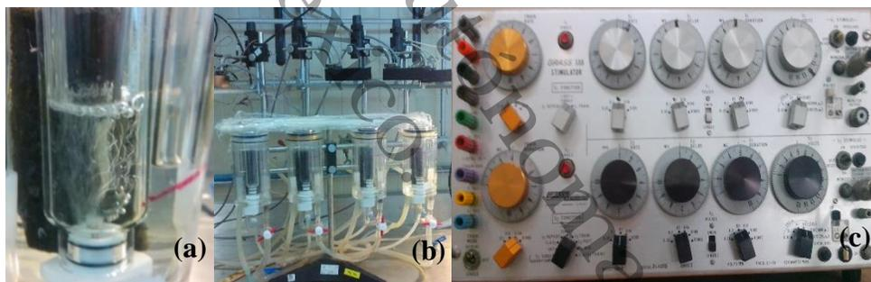
Fig. 12. Equipo para pruebas espasmolíticas: Íleon de cobayo en el portamuestra (a), portamuestra del equipo (b) y aparato que controla los pulsos eléctricos aplicados (c).
