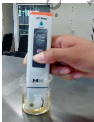
Figura 8. Medición del pH con un pHmetro digital
