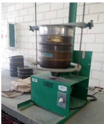
Figura 7. Tamizador mecánico utilizado para determinar la granulometría
