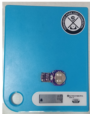
Figura 5.2. Comprobación de peso del hardware de los nodos.
