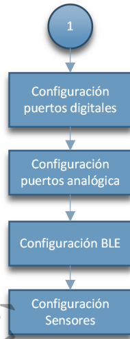
Figura 4.16. Diagrama de flujo de configuración de la aplicación Nodosensor
