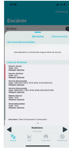
(b) Verificación de servicios usando la aplicación nRF Connect para IOS.
