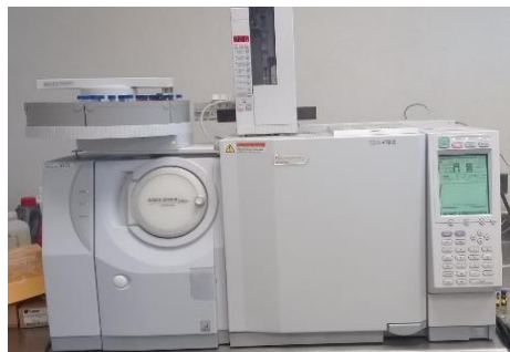
Fig. 2. 18 Cromatografo de gases Marca Shimadzu Modelo GC-2010 plus
