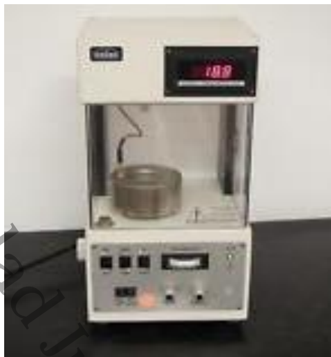
Fig. 2. 34 Tensiómetro digital Krüss modelo K 10 ST (Álvarez, 2009)
