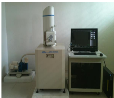
Fig. 2. 19 Microscopio electrónico de barrido marca JEOL modelo JSM-6010LA
