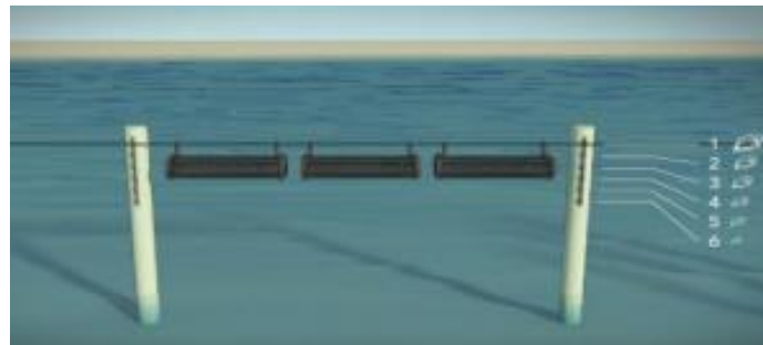
Figura 10.- Diagrama de la instalación de las canastas Australianas (SAGARPA, 2018)
