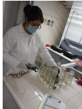
Figura A14. Caracterización de oxígeno disuelto.
