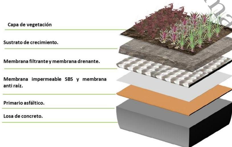
**Figura 1.** Componentes de un techo verde. Adaptado de Bolívar-Fuentes (2015).
