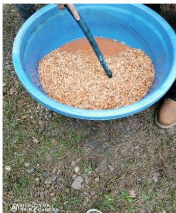
Figura 22. Lavado de los materiales filtrantes.
