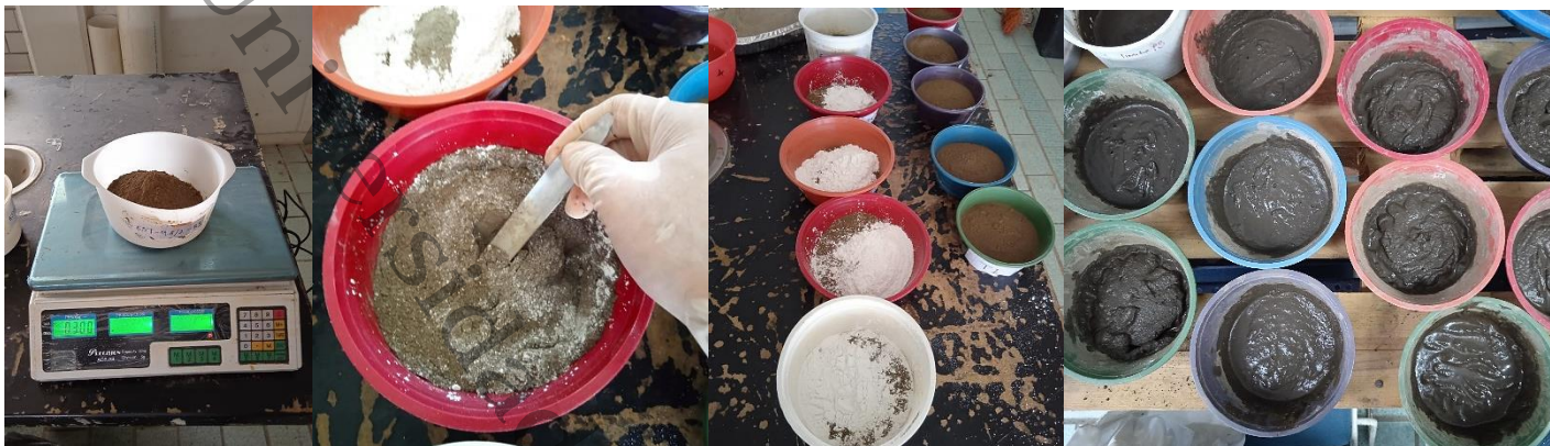
Figura 3. Adición y homogenización de cal y cemento Portland.
