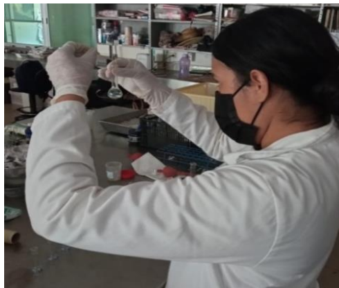
Figura 4 Serie de diluciones de solución madre
