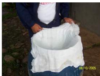
Figura 3.6 Colocación del colador o manta
