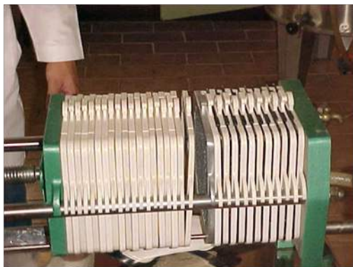
Figura 2.4 Filtro prensa empleado en la filtración de agua de coco. Univ. Tecnológica de Tabasco
