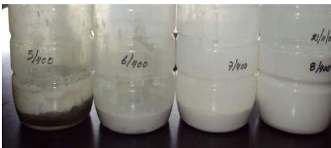
Figura 3. Degradación del látex con respecto a la concentración de  $\text{NH}_4\text{OH}$
