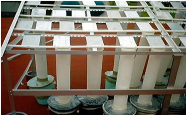
Figura 1. Montaje de las muestras para el runoff de los materiales expuestos
