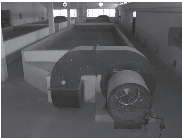
Figura 1. Secadora de galpón (Samoa) para secado de cacao.
