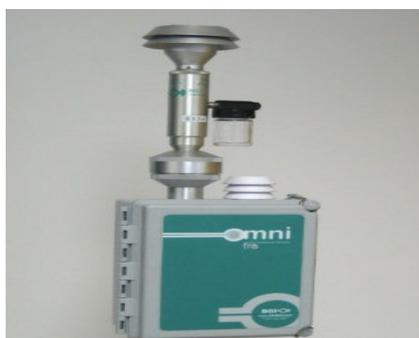
**Calibración del equipo.** Para la calibración del equipo, debido a que no hay una norma que incluya calibraciones de este tipo de equipos en el país. Se utilizó el calibrador que lleva el mismo equipo, de la marca Mesalabs modelo BGI Delta Cal el cual esta calibrado según los estándares de calidad de la EPA. El cual consiste en una consola portátil unida a cabezal el cual se coloca en la parte superior del equipo.
