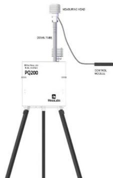
**Procedimiento después del monitoreo.** Al día siguiente, se abre la puerta del panel de control y se observa el tiempo de monitoreo, este debe ser 24 horas  $\pm$  1 hora. En la pantalla se observa la fecha y hora de inicio del
