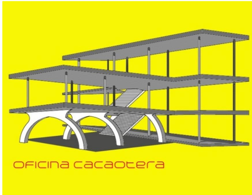
Figura 3. Esquema de la Oficina Cacaotera, con las Columnas (Pilotis) en Forma de Arcos de Medio Punto. Imagen Digitalizada Por El Autor.
