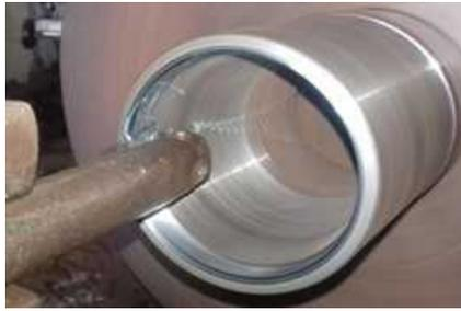
Figura 4. Manufactura de la rosca (hembra) en torno convencional.
