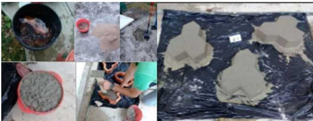
Figura 3. Proceso de fabricación del adoquín.
