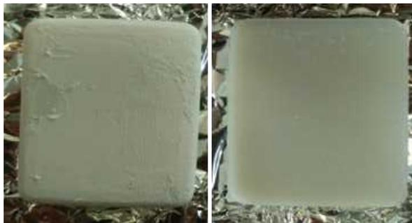
Figura 2. Monolito de  $\text{SiO}_2$  impregnado con una película de  $\text{TiO}_2$
