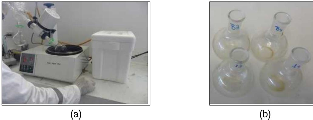
Figura 6. Obtención del biosurfactante. a) Separación mezcla solvente-biosurfactante, b) Biosurfactante purificado.
