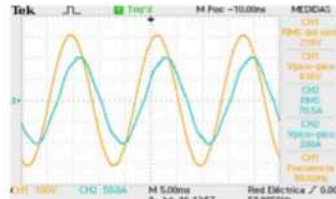
Figura 39-Voltaje de fase y corriente línea ( V_{ca}, I_{c6} )
