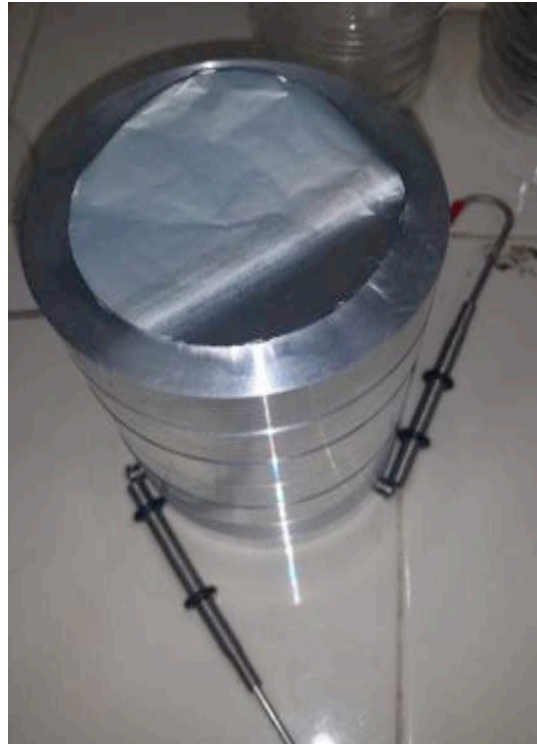
Equipo Andersen multietapas con filtro de aluminio.
