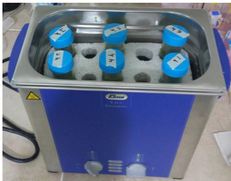
Figura 13. Equipo de ultrasonido con muestras de la cinética de extracción.
