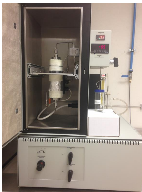
Figura 14. Equipo de extracción supercrítica SFT-150.
