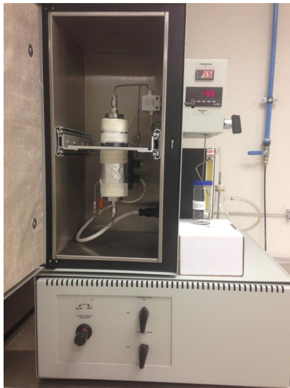
Figura 28. Equipo de extracción supercrítica SFT-150.
