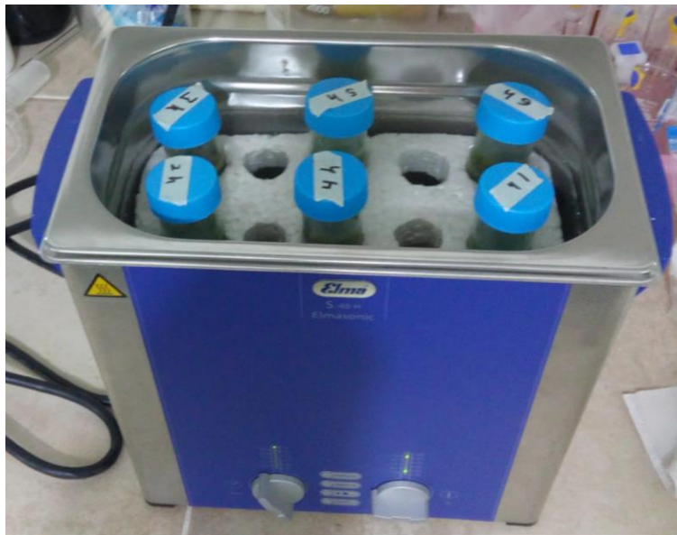
Figura 29. Equipo de baño ultrasónico Elmasonic S 40 H.
