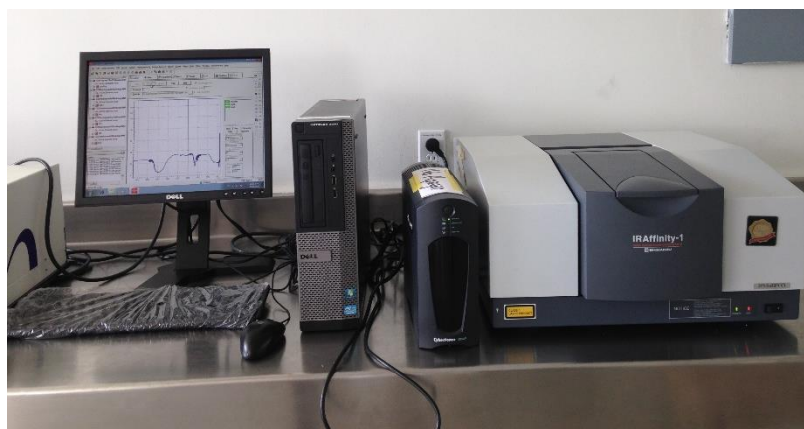
Figura 16. Espectrómetro FT-IR Shimadzu Modelo IRAffinity-1.
