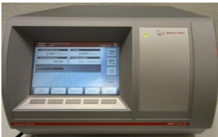
Figura 18. Densímetro Anton Paar DMA 4500M tipo capilar.
