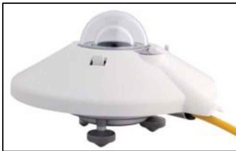
Figura 3.4. Medidor de irradiancia solar: Piranómetro Kipp & Zone, CMP 3.
