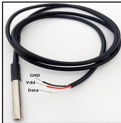
Figura 3.5. Sensor de temperatura: DS18B20.
