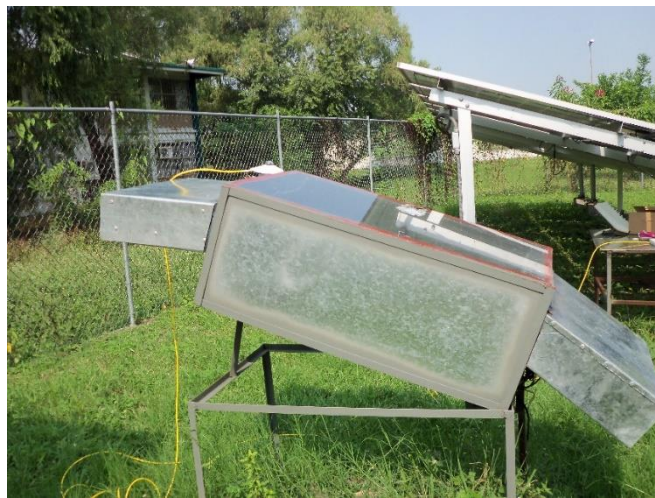
Figura 4.3. Implementación del colector solar.
