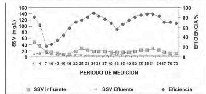
Gráfica 5 y 6. Variaciones de SST y SSV registrado en el influente y efluente del sistema durante 73 días de operación.
