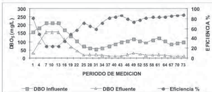
Gráfica 3 y 4. Variaciones de DQO y DBO registrado en el influente y efluente del sistema durante 73 días de operación.
