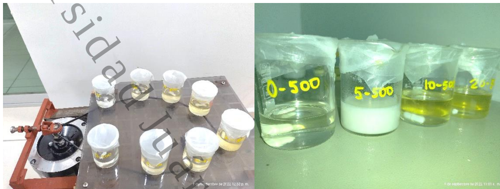
Figura A1. a) Síntesis de nanopartículas de \text{TiO}_2 y C- \text{TiO}_2 , b) Xerogeles de \text{TiO}_2 y C- \text{TiO}_2 .
