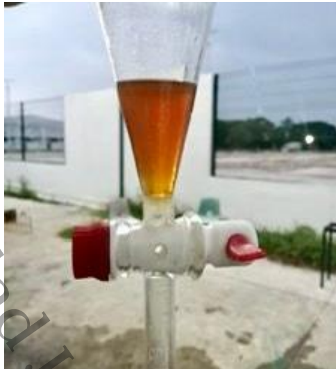
Figura 8. Recuperación del aceite pirolítico mediante embudo de separación.
