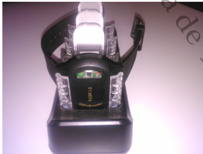
Figura 4.13: Smartwatch con sensor de movimientos marca GeneActiv.
