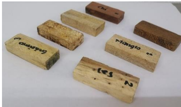
Figura 7: Muestras de 5 cm x 5 cm x 2 cm para determinación de densidad
