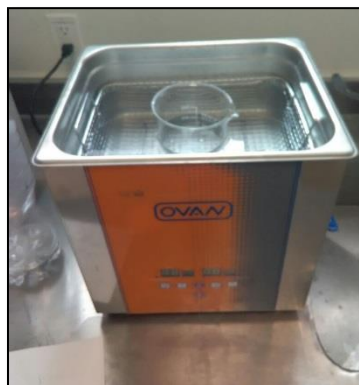
Figura 2.1.- El uso de baño ultrasónico permite remover las partículas pequeñas en la superficie del material, puesto que se generan diminutas burbujas por toda la superficie que remueven partículas pequeñas incrustadas en los poros.
