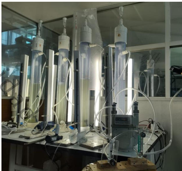
Inyección de biogás en el FBR 2, con dos medidores de flujo 200 kpa y un medidor de flujo por litros.
