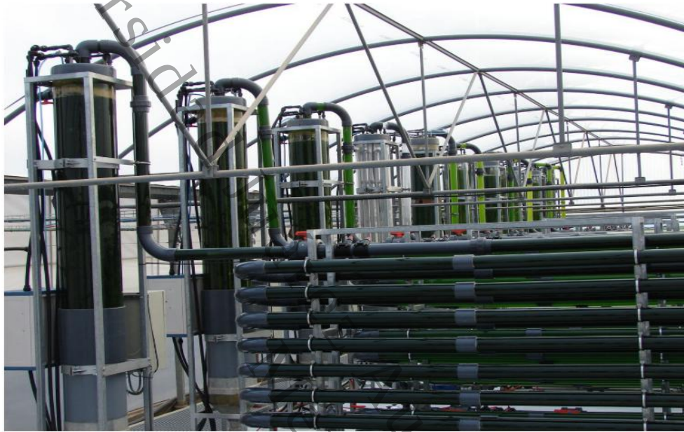
Figura 4. Fotobiorreactor cerrado tipo tubular para la producción de microalgas
