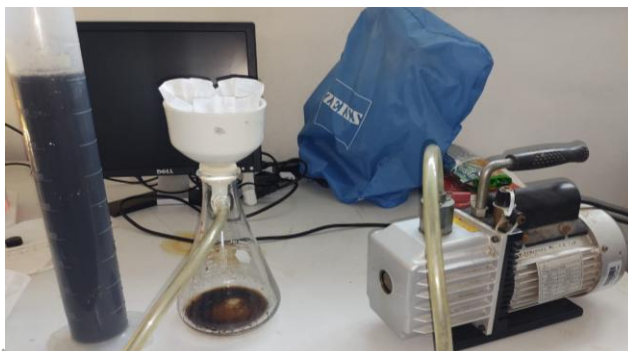
Purificación y esterilización del BiolCatre®; papel filtro sobre el embudo Buchner, anclado al matraz Kitasato conectado a una bomba al vacío. Autoclave
