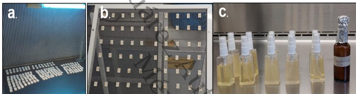
Figura 14. Preparación del bioensayo a) Exposición a rayos UV de litotipos para asegurar esterilidad b) Litotipos instalados en el bastidor c) Aspersores conteniendo los diferentes tratamientos.
