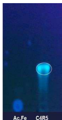
Figura 19. Cromatografía en capa fina en sílice en fase normal (Hex/AcOEt, 5 80:20 %) del compuesto aislado ( Ij-CDC4-R5 ), revelado con luz UV de longitud onda corta, comparado con estándar de ácido ferúlico.
