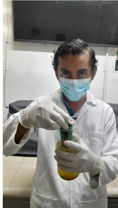
Figura 24. Medición del POR de las muestras de agua en la etapa de estabilización.
