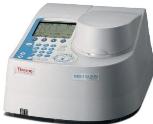
Figura 10.- Equipo UV-Vis empleado en el proyecto.
