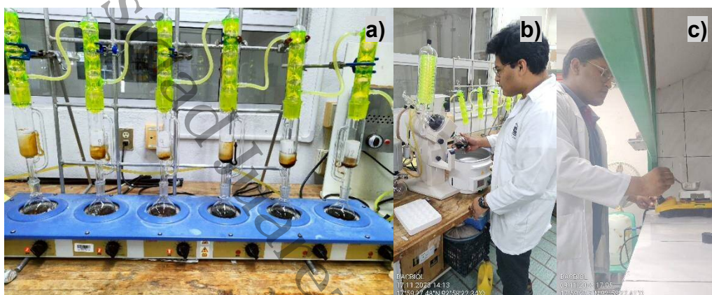
Figura 9: Se muestra la extracción de hidrocarburos totales de petróleo (HTP) del suelo: a) Sistema de extracción soxhlet puesto a reflujó por 8 horas, b) recuperación de solvente y c) evaporación de solvente residual en HTP.
