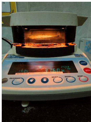
Figura 7: Determinación del porcentaje de humedad utilizando termobalanza
